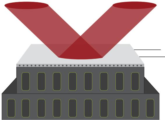
Tutti i sensori a specchio raffreddato misurano la temperatura alla quale l'umidità viene condensata fornendo una lettura del punto di rugiada. Questa tecnica fondamentale dona un'accuratezza ed un'affidabilità della misura senza uguali. Gli igrometri a specchio raffreddato vengono spesso utilizzati come standard di calibrazione per l'umidità.
