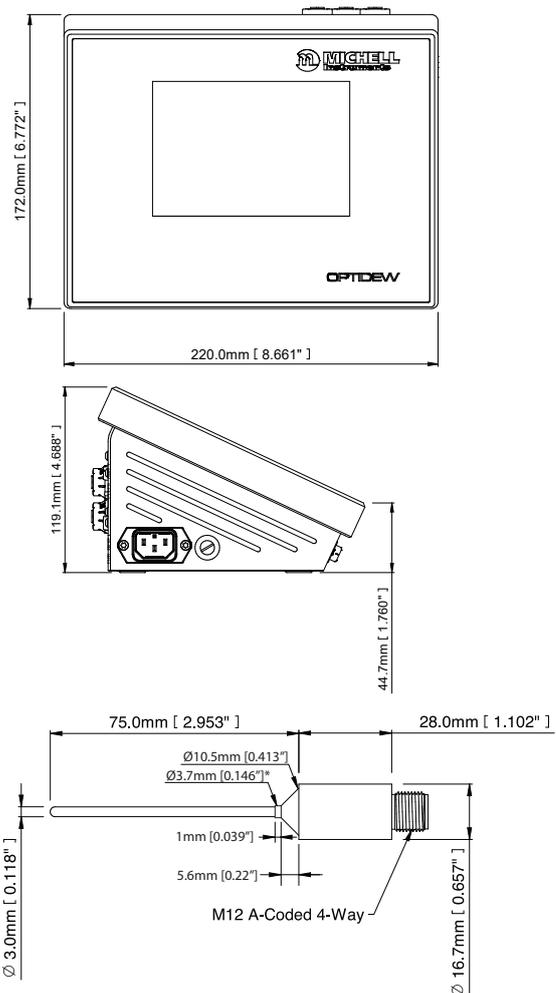
\*La saldatura può estendersi di 1mm verso la punta della sonda
