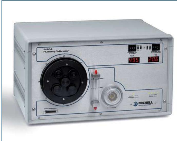
Il generatore di umidità e temperatura S904 e' progettato per effettuare operazioni di calibrazione e verifica di sensori di umidità relativa e temperatura. Questo strumento è in grado di generare, all'interno di una camera di integrata, valori di umidità relativa nel range dal 10 al 90% UR, con una temperatura selezionabile, compresa tra 10 e 50°C, ed un'uniformità di misura di ±0,1°C. Effettuare calibrazioni accurate e ripetibili e' ora più semplice.
