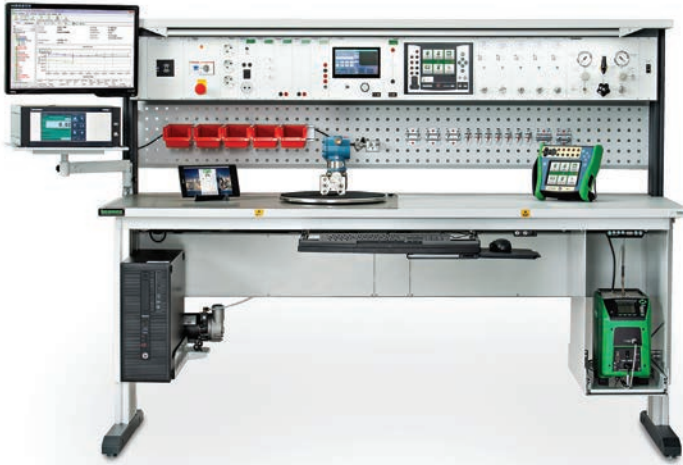
Banchi e carrelli mobili di taratura Beamex CENTRiCAL.
