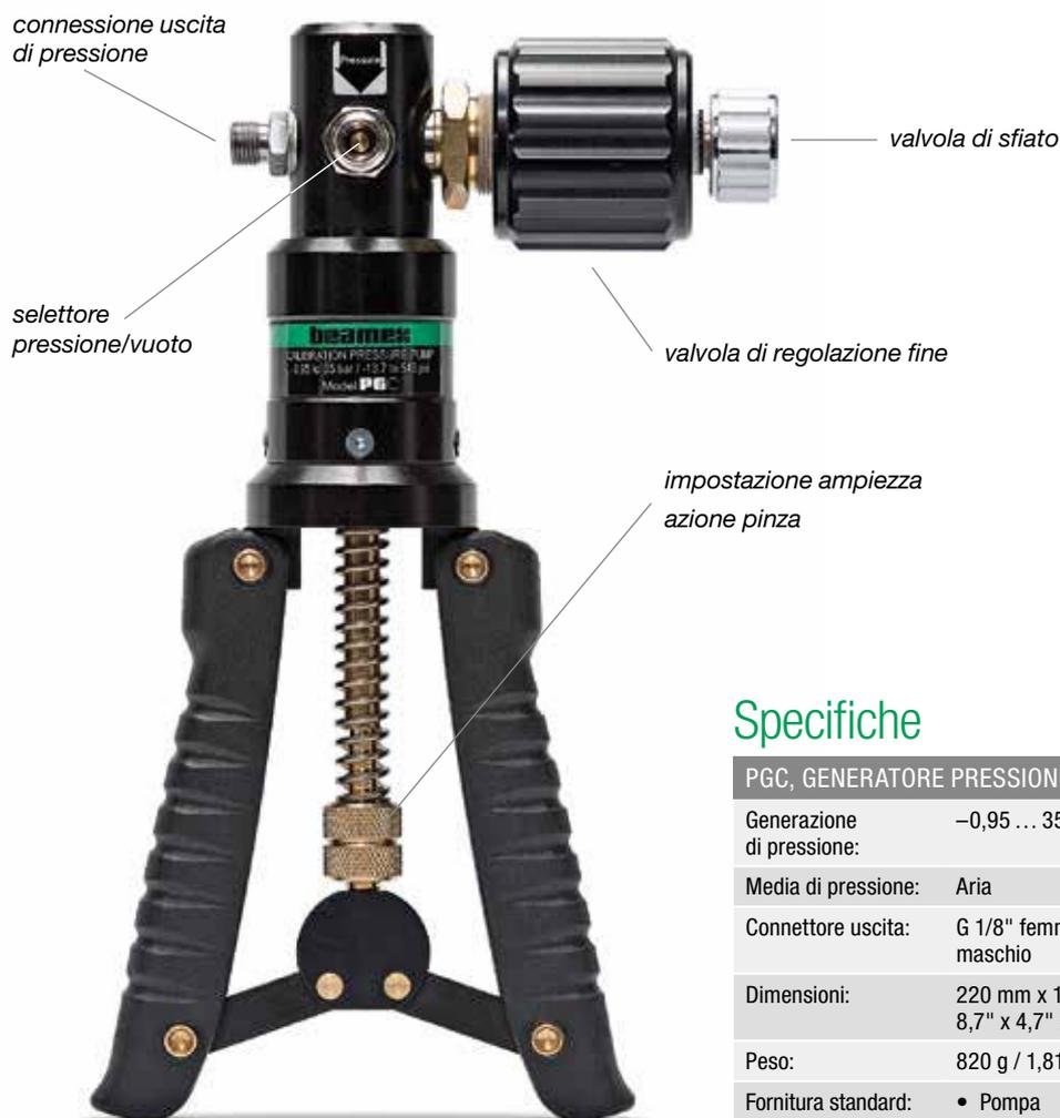
**La PGC** è una pompa di taratura manuale che può essere utilizzata per generare pressione e vuoto. Utilizzando il selettore pressione/vuoto è possibile selezionare rapidamente cosa generare. La regolazione accurata rende possibile configurare in modo preciso la pressione generata.
